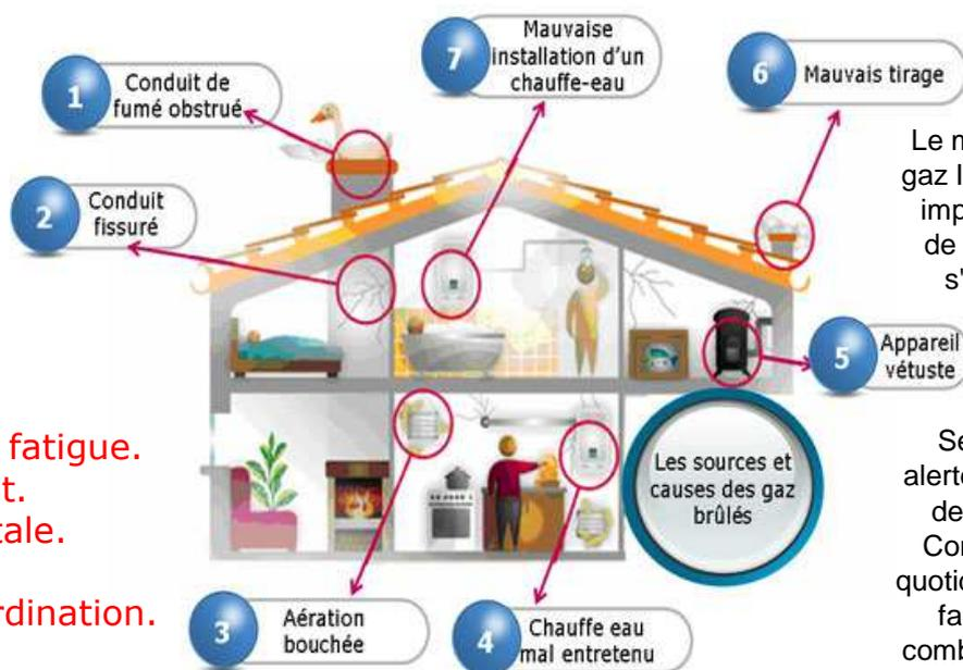
Le monoxyde de carbone est un gaz INVISIBLE (inodore, incolore, imperceptible). Le seul moyen de déceler sa présence est de s'équiper d'un détecteur de monoxyde de carbone.
